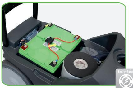
Batteries avec technologie Dry Cell qui ne nécessite pas de maintenance. Très bas niveaux de auto-décharge et matériaux presque entièrement recyclables.
