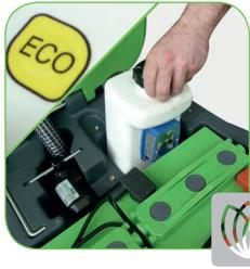
Système de dosage de détergent séparé de la distribution d'eau. Permet des économies substantielles sur les produits chimiques. Le réservoir peut être facilement enlevé.
